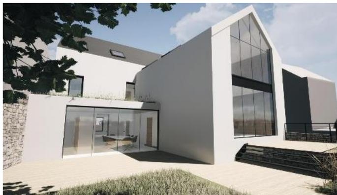
En façade arrière, le corps principal existant (perpendiculaire à la Place de la Halle, niveau de référence +93cm) s'ouvre complètement vers le jardin. Des ouvertures seront également réalisées à l'étage du corps principal parallèle, et rendues possibles via la suppression des anciennes extensions. Enfin, une nouvelle extension (niveau de référence 000), entièrement ouverte vers le jardin, sera réalisée au rez-de-chaussée. Ces espaces pourront accueillir différentes activités et
